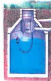
Ce dispositif permet une mise en aspiration verticale lorsque les berges sont difficiles d'accès. Le puisard peut être équipé d'une colonne fixe d'aspiration. Les engins sont en station sur une aire d'aspiration aménagée.
